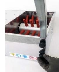
9. Die Beine befestigen, indem man die Drehgriffe in die Löcher einschraubt.
