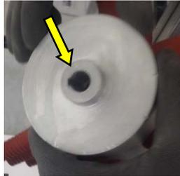
6. Die neue Walze einführen und solange drehen, bis der Keil an der Motorwelle in den Sitz auf der Walze einrastet.
