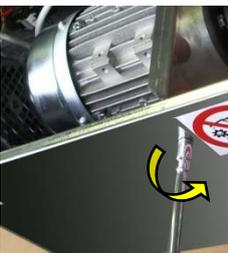
6. Die vier Bolzen seitlich am Gehäuse lösen und die Seitenwand ausbauen, an der der Motor und die Walze befestigt sind.
