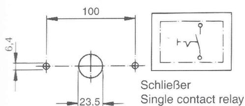
**Batterietrennschalter 12V / 24V** 0 341 002 003
