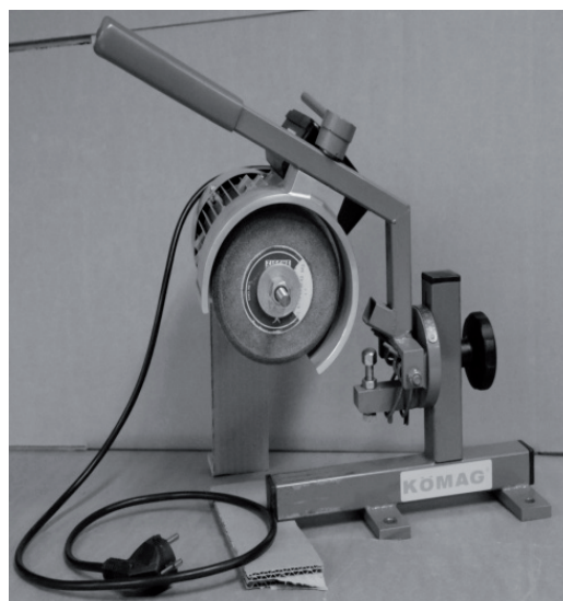
Grundgerät mit Elektromotor 220V 180W, 2750 min -1 , rechts-/Linkslauf mit 1,5m Kabel
