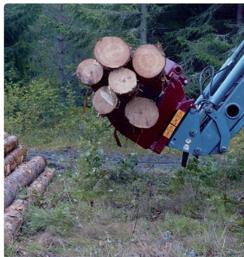
Der gebogene Oberkiefer hält das Holz während des Transports im sicheren Griff. Dies wird deutlich auf dem Bild oben gezeigt.
