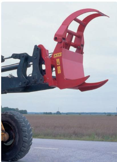
Das FAIE Frontpolterschild lässt sich weit öffnen und vereinfacht dadurch das Aufladen von Holz und Reisig. Der Hydraulikzylinder befindet sich gut geschützt hinter einer Metallplatte, um nicht beschädigt zu werden und um kostspielige Reparaturen zu vermeiden.
